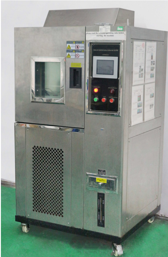
Cámara climática, con rango de ajuste de temperatura de -90 a +150^{\circ}C , rango de ajuste de humedad relativa de 1 a 100 %
