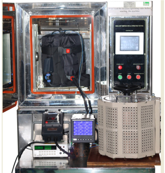
Calentadores de chaqueta durante pruebas climáticas en temperaturas negativas
