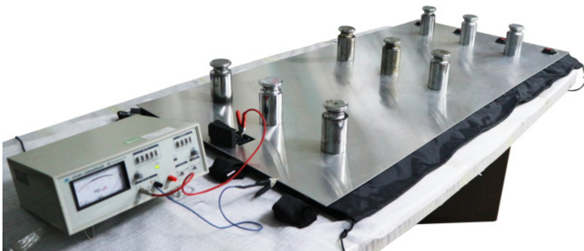
Dispositivo para medir la resistencia de aislamiento. Los valores medidos son siempre mayores a 0,1 Gohmios
